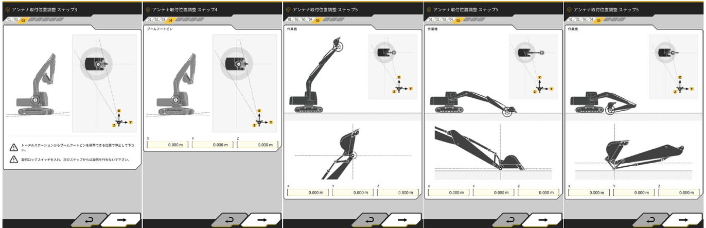
4. GNSSメイン/サブアンテナの位置をトータルステーションで計測します。(ステップ6)
