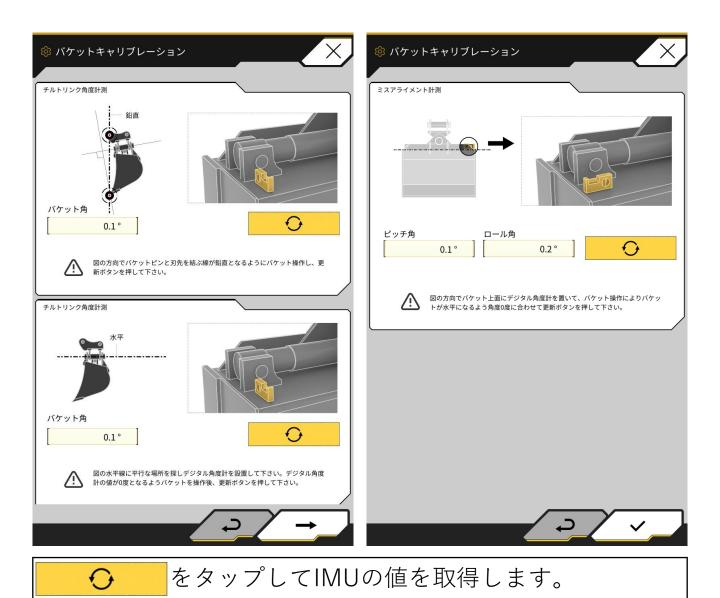
デジタル角度計を使用してバケット操作してください。
