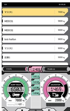
Si se carga el camión con el peso objetivo sobrepasado, entonces el medidor del peso de carga cambiará a color rojo.
