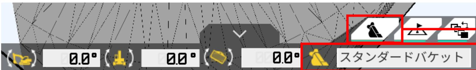
タップで「バケット角・設計面までの距離」と「バケット名」を表示切替
