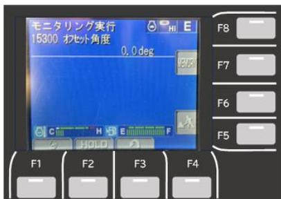
表示されているオフセット角度が0.0degとなるように作業機をオフセットさせて下さい。
